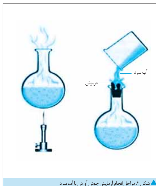
▲ شکل ۲. مراحل انجام آزمایش جوش آوردن با آب سرد
